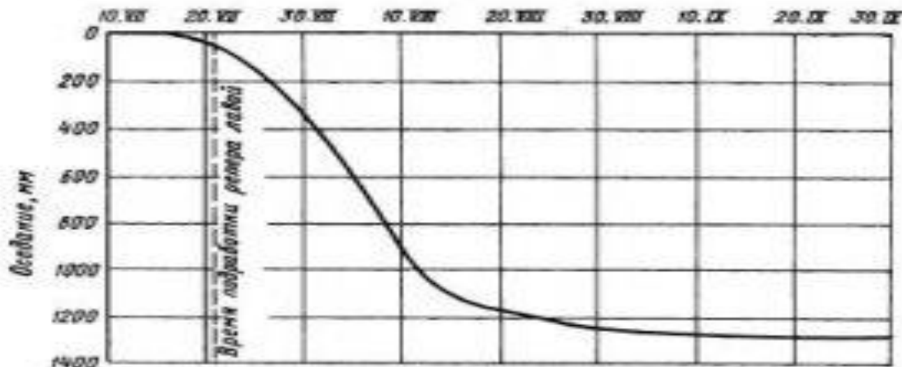
Рис. XII.16. Кривая оседания репера для условий Томь-Усинского месторождения
