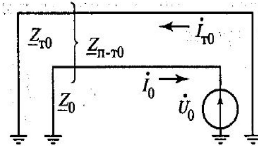
Для эквивалентного фазного проводника падение напряжения:
