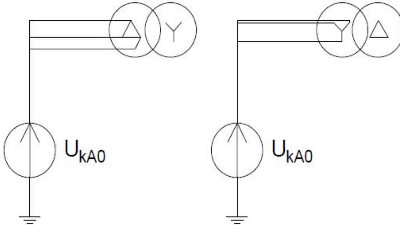
При КЗ со стороны треугольника или незаземленной звезды  $X_0 = \infty$ , так как ток нулевой последовательности не может вернуться в источник.
