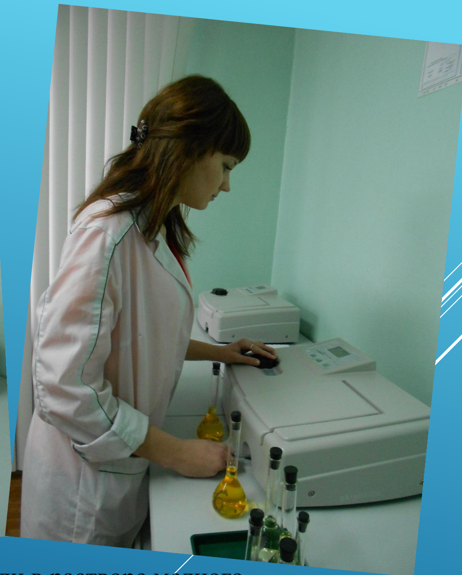
Определение содержания меди в растворе медного купороса
