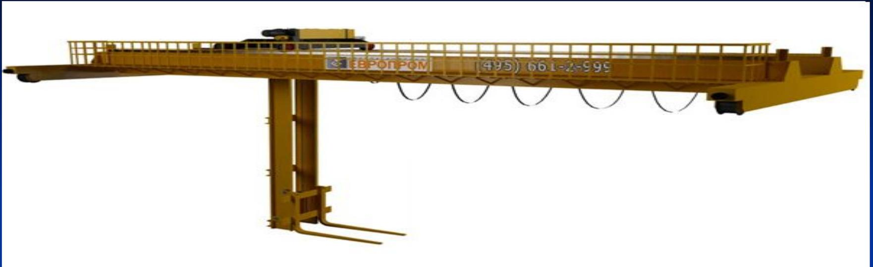
Мостовой кран-штабелер представляет собой крановый мост, по которому перемещается грузовая тележка с закрепленной на ней вертикальной колонной, как правило поворотной, по которой вертикально перемещается грузоподъемник (каретка), имеющий вилочный или специальный захват груза.
