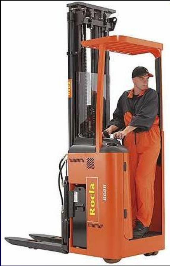
Управление штабелёром осуществляется из кабины, благодаря чему снижается усталость оператора, повышается концентрация внимания. Такой тип штабелеров имеет высокую скорость передвижения.
