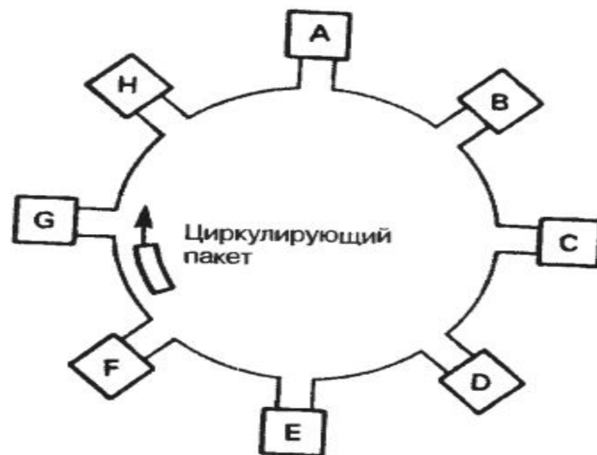
Рис. 5.27. Пустой сегмент и передача маркера в сети
