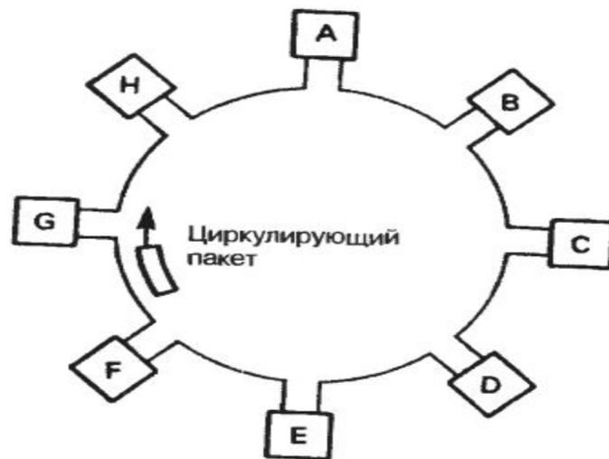
Рис. 5.27. Пустой сегмент и передача маркера в сети
