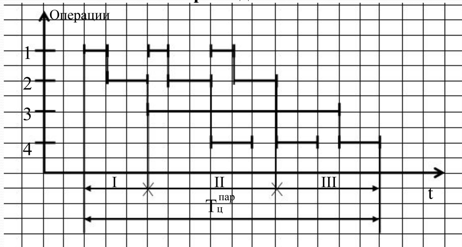
Как видно из графика, длительность цикла обработки деталей при параллельном методе в сравнении с последовательным сократилось, однако, возникли перерывы в работе оборудования на всех операциях, кроме самой продолжительной.
