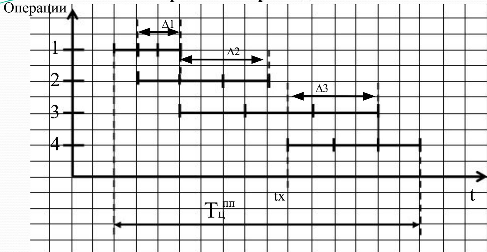
Как видно из графика, при последовательно-параллельном методе обеспечивается сокращение длительности цикла обработки партии в сравнении с последовательным методом и устраняются перерывы в работе оборудования.
