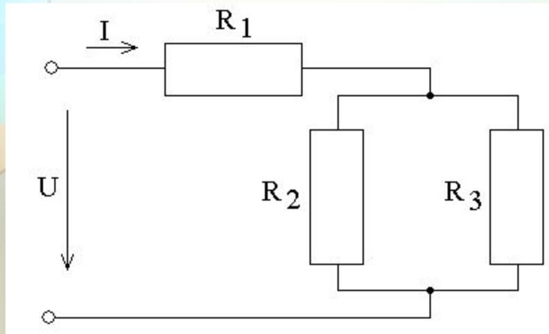
При расчете таких цепей вначале определяют сопротивления параллельно или последовательно соединенных групп, после чего определяют сопротивление всей цепи.
