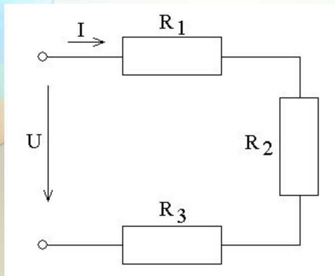
Конец первого резистора соединяется с началом второго, конец второго с началом третьего и т.д.
