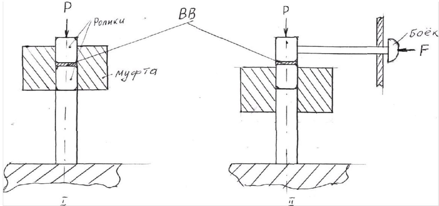
Рис. 3.1 Схема постановки опыта по определению чувствительности ВВ в ударном трении (пояснения в тексте)
