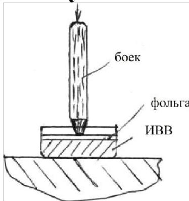
Рис. 3.4 Схема определения чувствительности ИВВ в удару
