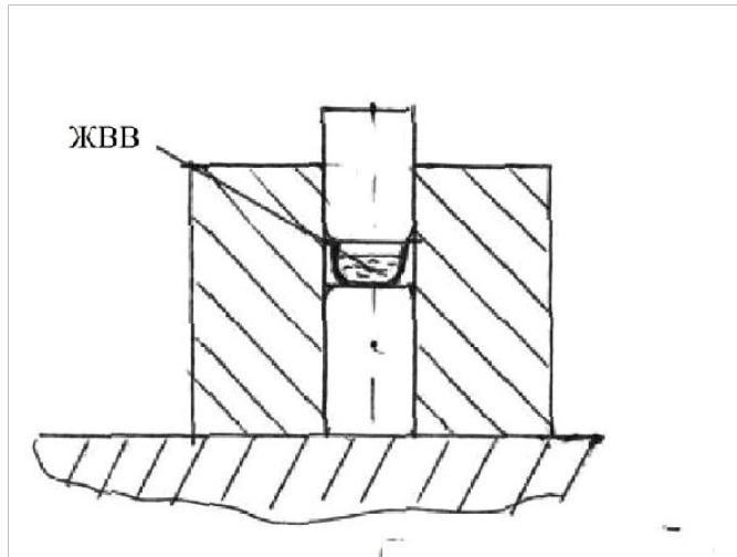
Рис. 3.5 Схема определения чувствительности ЖВВ в удару
