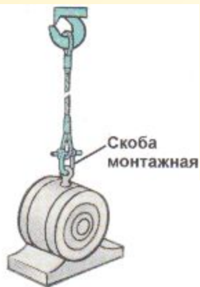
СТРОПОВКА ЭЛЕКТРОДВИГАТЕЛЯ ДВУХПЕТЛЕВЫМ СТРОПОМ
