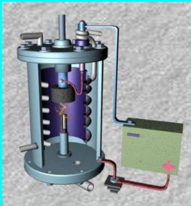
Плазменно-дуговой метод синтеза углеродных наноструктур, активированных катализатором (Pt, Pd)
