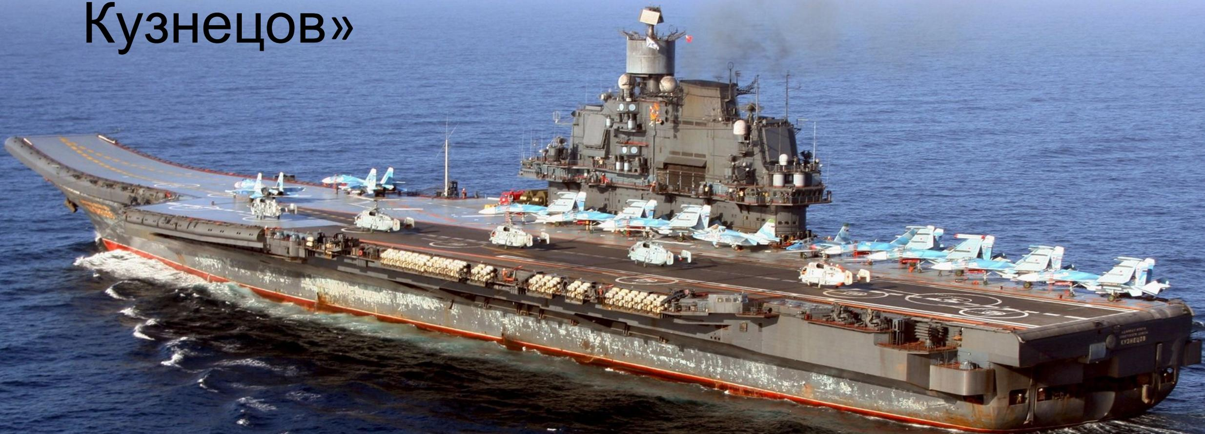
Предназначен для поражения крупных надводных целей. Приспособлен для обслуживания и базирования 28 самолётов и 24 вертолётов.
