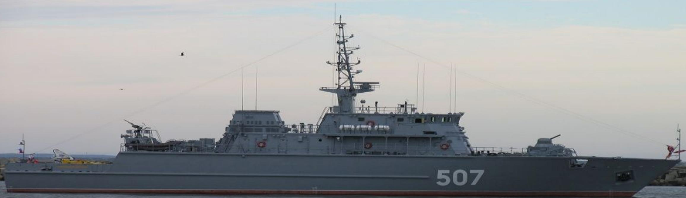
Тральщик – корабль специального назначения, используемый для поиска, обнаружения и ликвидации морских мин, а также для проводки кораблей и судов сквозь минные заграждения.
