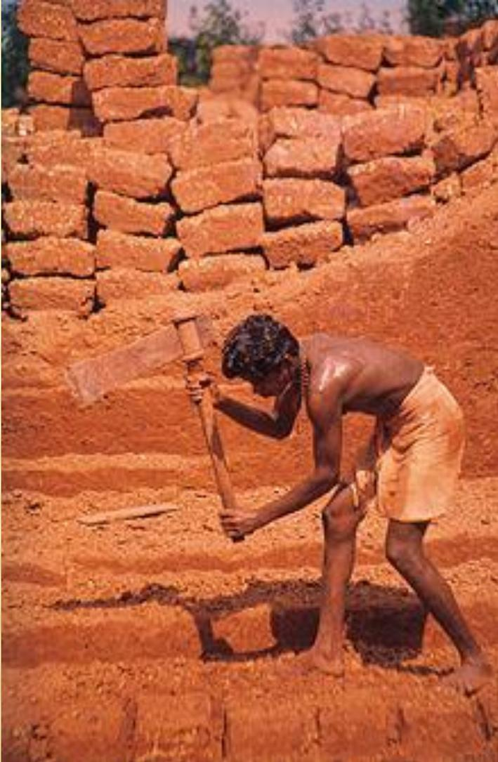
**L** – латерит – очень твердый сплошной железистый горизонт (панцирь). Состоит преимущественно из оксидов железа и алюминия с примесью кварца и каолинита. Образуется за счет необратимой дегидратации и кристаллизации оксидов железа из железистой матрицы вышедшего на поверхность плинтита
