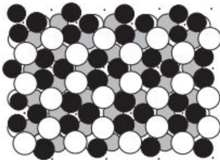
Рисунок 3 – кристаллическая структура. Результат нанесения в равновесных условиях одного монослоя золота на эту поверхность  $\text{Si}(111)7 \times 7$  в сверхвысоком вакууме. Образуется уже другая структура, с периодичностью в корень из трех раз большей, чем у объемного кремния. К тому же новая решетка повернута относительно основной на 30 градусов. Вот так располагаются атомы золота на монокристалле кремния, если их нанести один монослой, а подложку нагреть, это видно благодаря методу ДМЭ.
