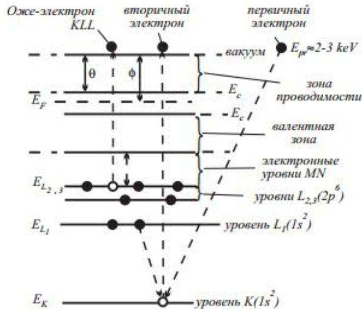
Рисунок 2 – схема Оже-перехода:
