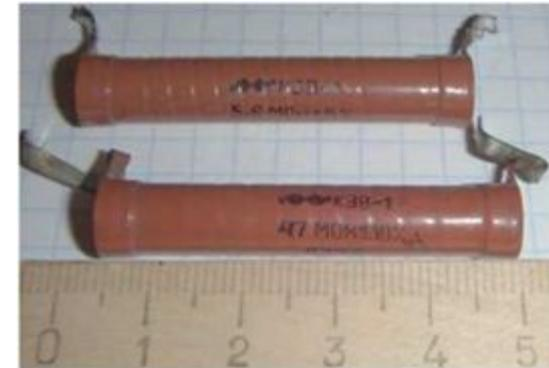
**3. Высокочастотные резисторы** - преимущественно поверхностного типа. Предназначены для аппаратуры, работающей на частотах свыше 10 МГц, кабелях, волноводах. Используют при конструировании высоко- и сверхвысокочастотных трактов аппаратуры в качестве согласующих нагрузок, аттенюаторов, эквивалентов антенн, элементов волноводов.
