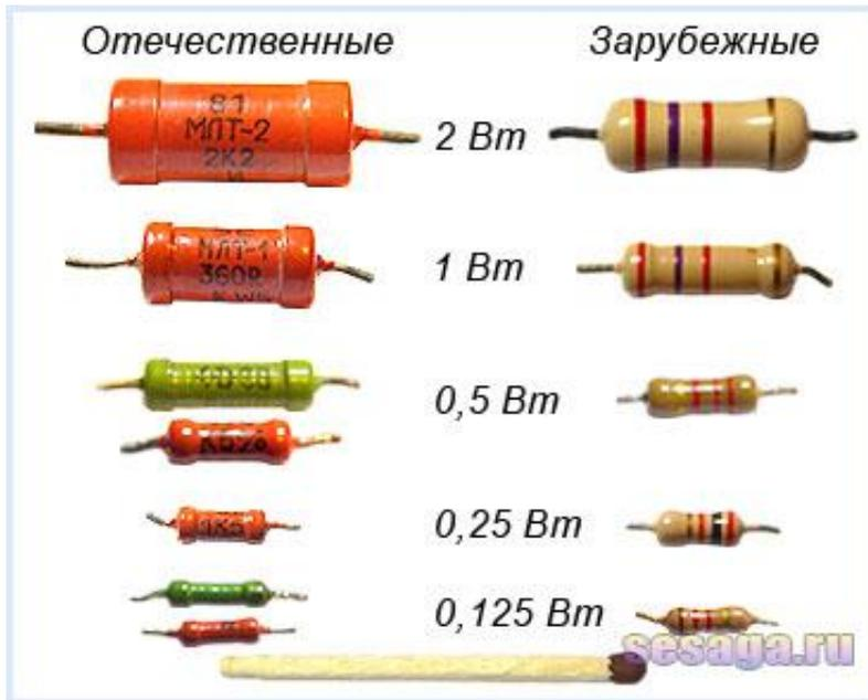
Величина  $P_{ном}$  определяется конструкцией, физическими свойствами материалов проводящего элемента и защитного слоя. С повышением температуры окружающей среды  $P_{ном}$  снижается.
