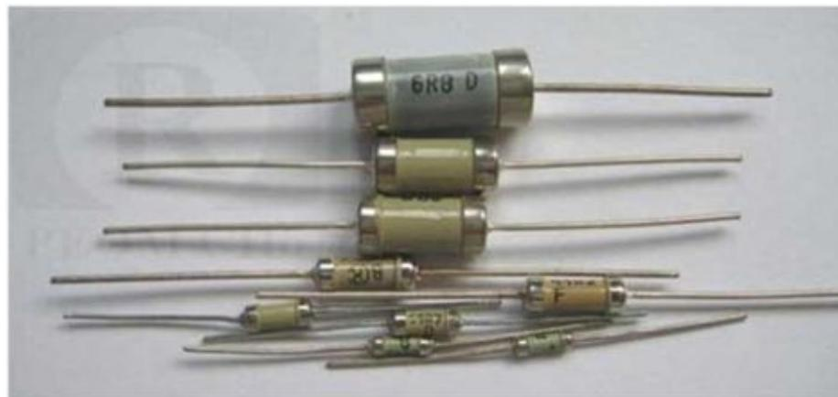
**4. Прецизионные и полупрецизионные резисторы)** - применяются в точных измерительных устройствах, релейных системах, магазинах сопротивлений. Отличаются высокой точностью изготовления, повышенной стабильностью основных параметров, часто выполняются герметизированными. Величины сопротивлений 0,1 Ом -1 МОм,  $P_{ном}$  не более 10 Вт. Типы: БЛП, С2-10, С2-13 и др.
