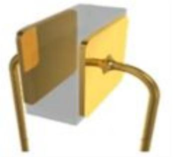
**Конденсатор** — это элемент электронной техники, содержащий два или более проводников: электроды или обкладки, разделенные диэлектриком (рабочий диэлектрик). Электрические свойства, конструкция и области применения конденсатора определяются использованным в нем рабочим диэлектриком.
