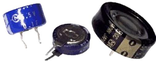
**Ионистор** (двухслойный электрохимический конденсатор, суперконденсатор, ультраконденсатор) — электрохимическое устройство, конденсатор с органическим или неорганическим электролитом, "обкладками" в котором служит двойной электрический слой на границе раздела электрода и электролита. Представляет собой гибрид конденсатора и химического источника тока.
