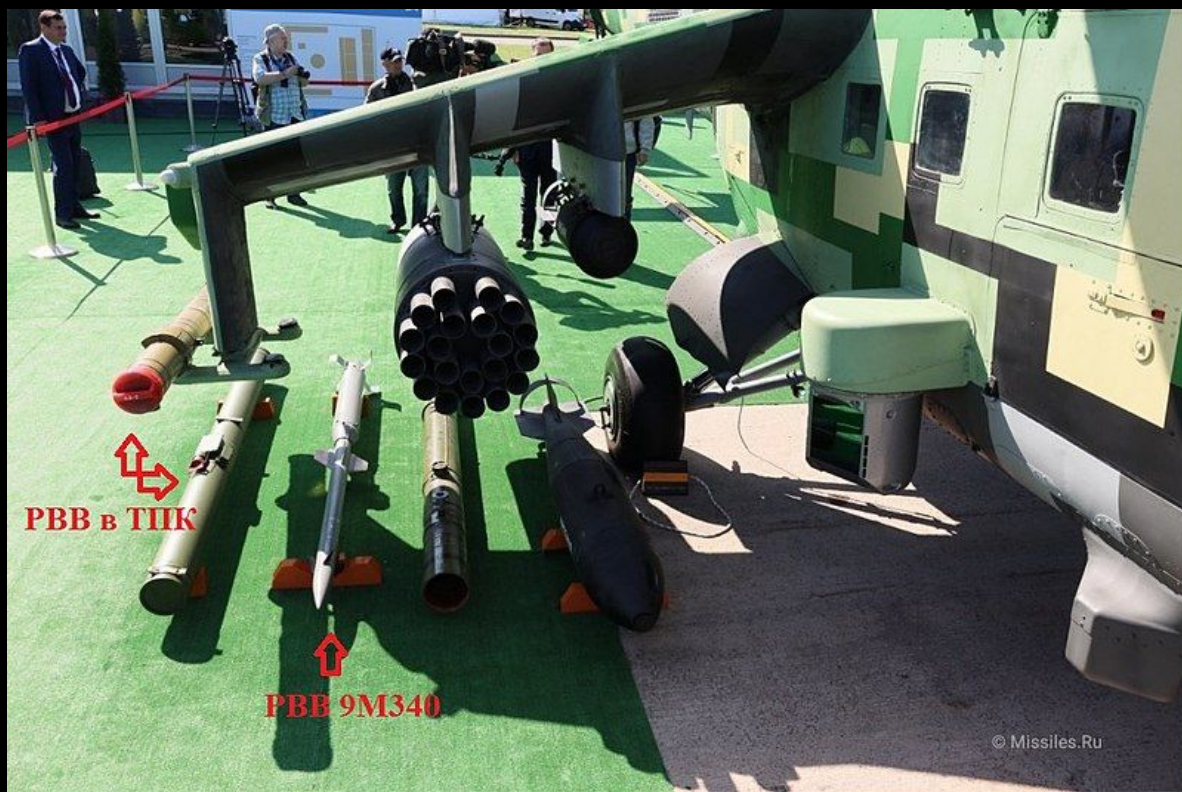
Ракеты "Воздух-воздух" 9М340 и 9М337, аналогичные ЗРК "Сосна". Они же в ТПК на законцовке полноразметного крыла. Видны неубирающиеся шасси, элементы новейшей КОЭП и системы РЭБ.
