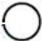
(окружность диаметром 3–5 мм.), выполняемый тонкой линией.
