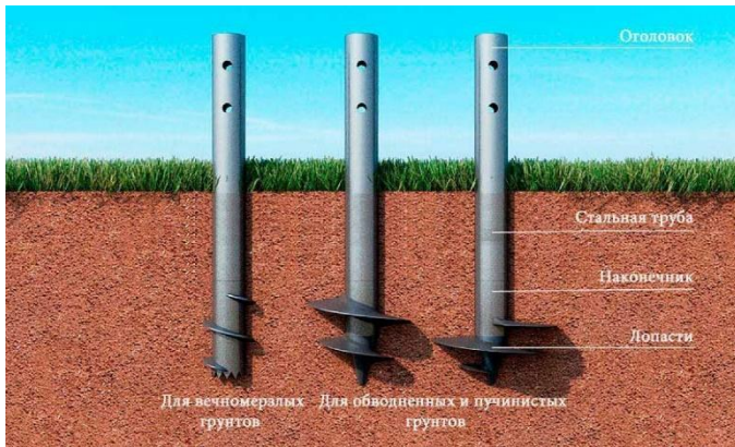
Рисунок 34. Устройство винтовых свай
