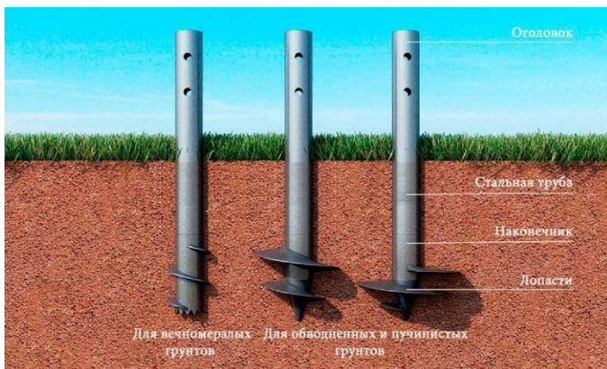
Рисунок 34. Устройство винтовых свай
