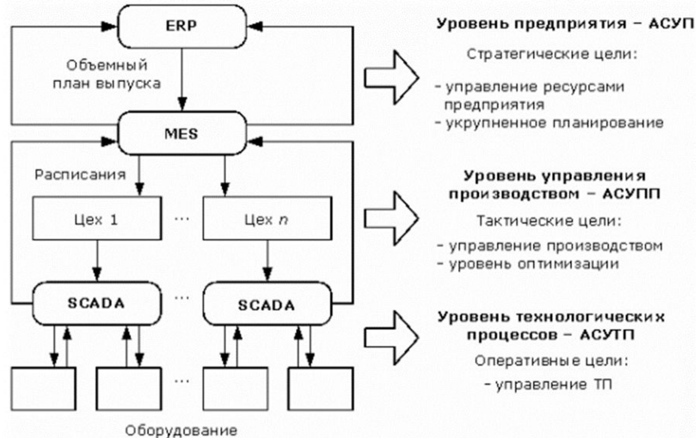
Рис 1. Структура децентрализованной АСУП
