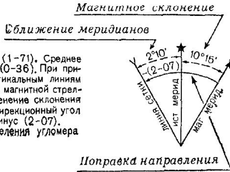
Рис. 31. Схема магнитного склонения, сближения меридианов и поправки направления
