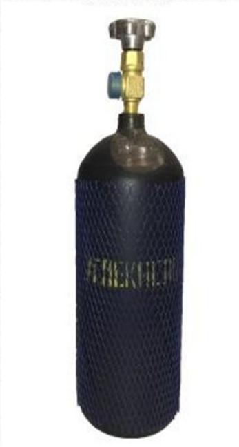
Углекислый газ CO<sub>2</sub> выпускают по ГОСТ 8050–76 трех марок. Для сварки используют сварочный газ чистотой не менее 99,5%. Хранят и транспортируют его в жидком виде в стальных баллонах емкостью 40 литров под давлением 6–7 МПа. Баллон окрашивают в черный цвет. Углекислый газ относится к окислительным. Поэтому его в основном используют для сварки низкоуглеродистых и низколегированных сталей. Назначение его состоит в защите расплавленного металла от азота воздуха
