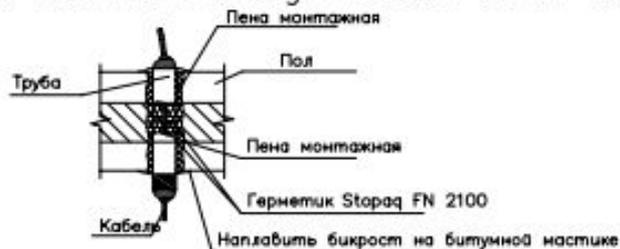
Узел монтажа ввода кабеля в ЦРП
