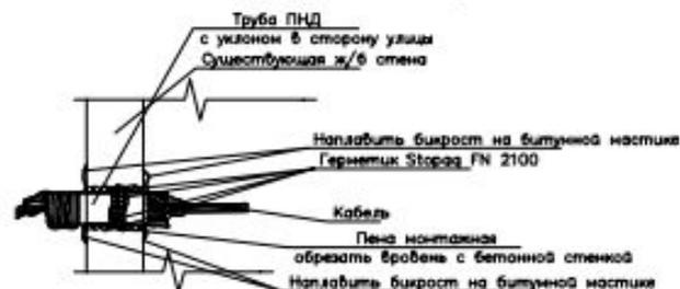
Узлы монтажа кабельных линий 0,4кВ
