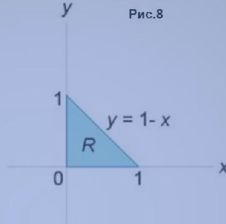
Данное тело (рис.7, 8) расположено над треугольной областью  $R$ , ограниченной координатными осями  $Ox$ ,  $Oy$  и прямой  $y = 1 - x$  ниже параболической поверхности  $z = x^2 + y^2$ . Объем тела равен
