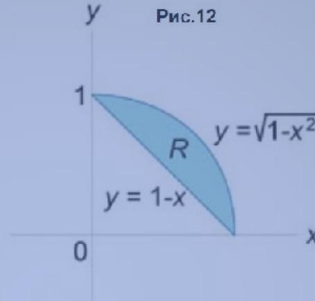
Как видно из рисунков 11 и 12, в области интегрирования  $R$  при  $0 \leq x \leq 1$  значения  $y$  изменяются от  $1 - x$  до  $\sqrt{1 - x^2}$ . Сверху тело ограничено плоскостью  $z = 1 - x$ . Следовательно, объем данного тела равен
