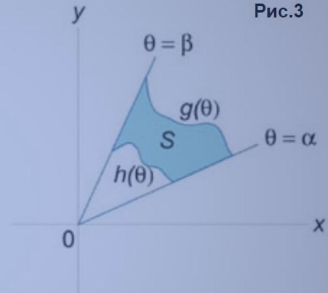
Объем тела, ограниченного сверху поверхностью  $z = f(r, \theta)$  с основанием  $S$ , выражается в полярных координатах в виде
