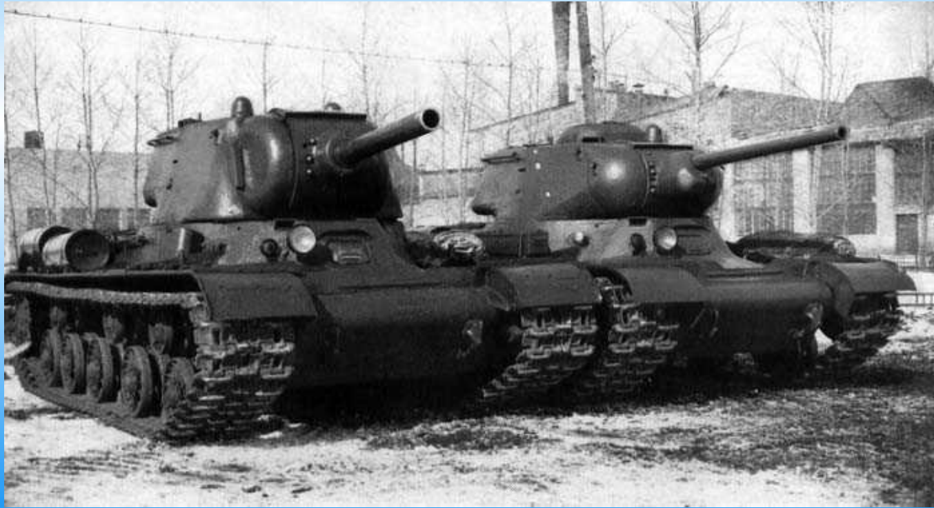
Средний танк КВ-13 и его конструктивное развитие «Объект 234» (промежуточный вариант перед танком ИС). У него ещё было пять катков (на ИС добавили шестой), а в башне установлена 122-мм гаубица У-11
