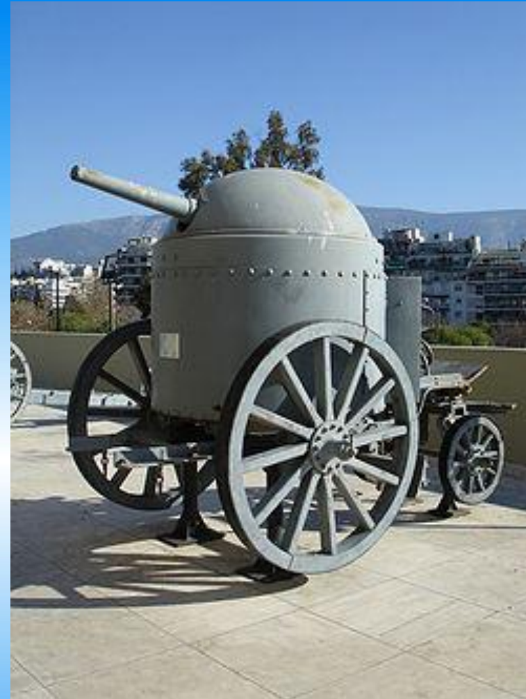
Бронекаретка Шумана . Пушечная (57-мм) бронеплатформа с конной тягой болгарской армии времен Первой мировой войны
