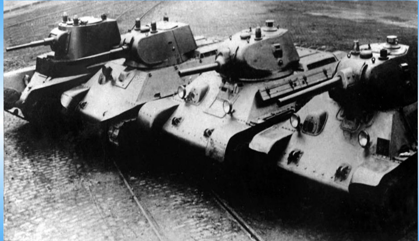
Довоенные танки производства завода №183 (г. Харьков). Слева направо: БТ-7 (А-8), А-20, Т-34–76 с пушкой Л-11 (1940 г.), Т-34–76 с пушкой Ф-34 (1941 г.)
