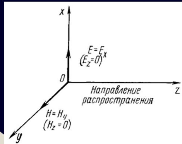
Структура электрического и магнитного полей Т-волны на примере коаксиальной линии
