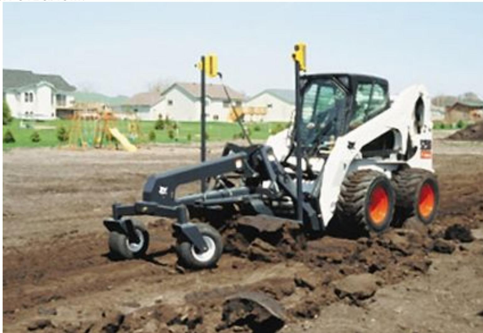
Однако считать ее грейдером можно лишь с натяжкой – ведь для этого универсала предусмотрено более 60 сменных навесных агрегатов. Производители позиционируют его как погрузчик с функцией автогрейдера. В навесном агрегате передние колеса не управляются, и поворот производится за счет задней тележки. Ширина ножа-отвала чуть более двух метров. Для частных пользователей и садоводов-любителей европейская промышленность выпускает «ручной грейдер» Strakvlak – его фото ниже:
