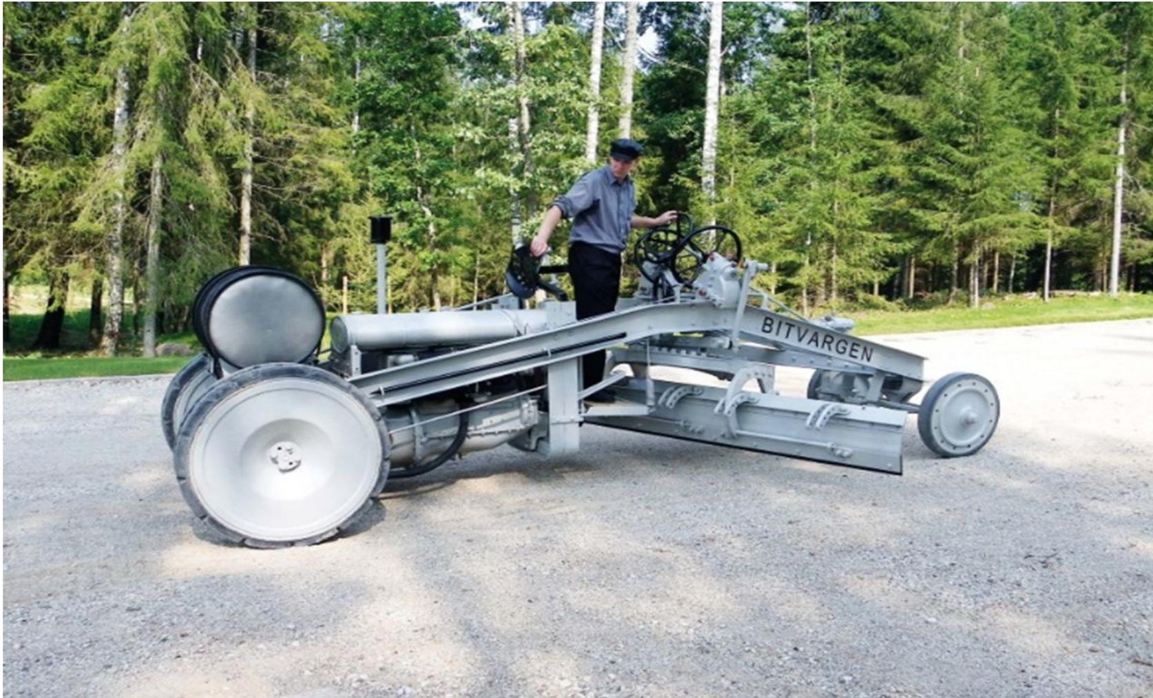
У этой модели мы видим сплошные резиновые шины, двигатель внутреннего сгорания и ручное управление рабочим органом. Аналогичные модели выпускали и на гусеничном ходу
