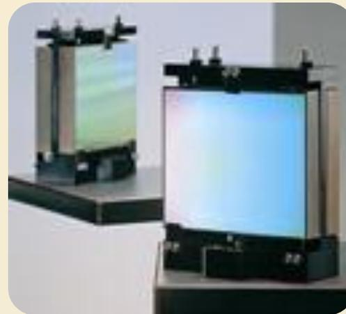
**Дифракционная решетка** — оптический прибор, работающий по принципу дифракции света, представляет собой совокупность большого числа регулярно расположенных штрихов, нанесенных на поверхность.
