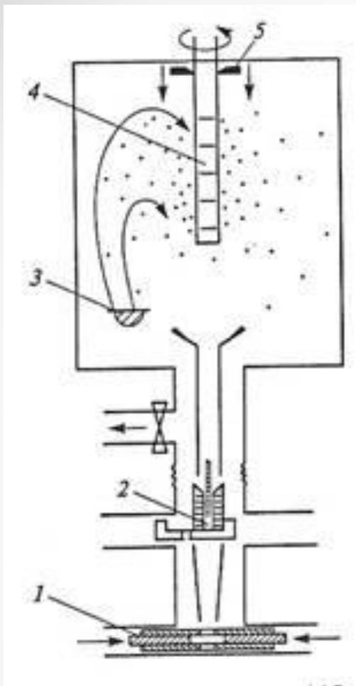
Схема установки Глейтера: 1 - узел компактирования при высоком давлении; 2 - узел предварительного прессования; 3 - испаритель; 4 - вращающийся коллектор, охлаждаемый жидким азотом; 5 - скребок
