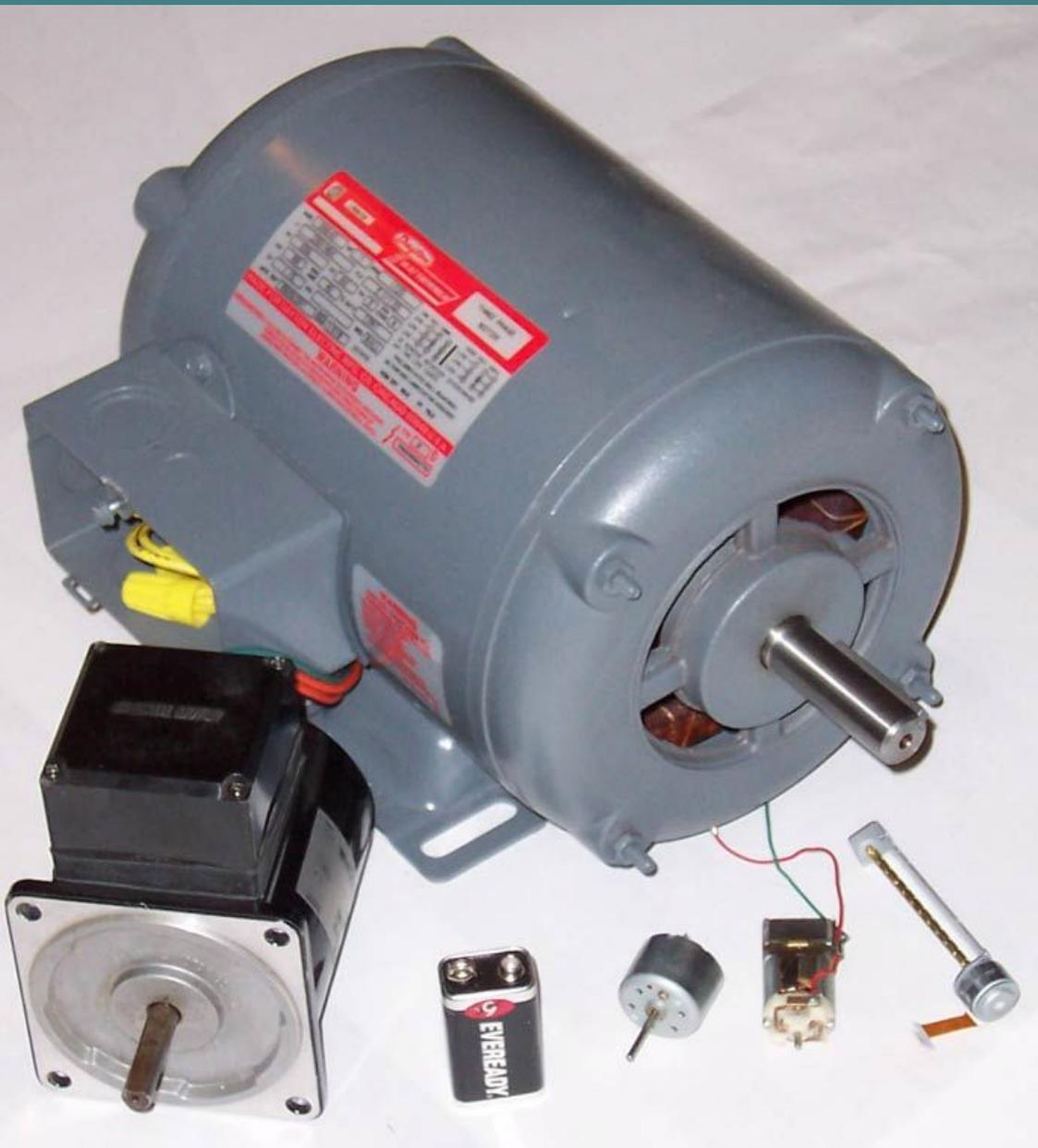
**Электрический двигатель** — это электрическая машина, в которой электрическая энергия преобразуется в механическую, побочным эффектом является выделение тепла.
