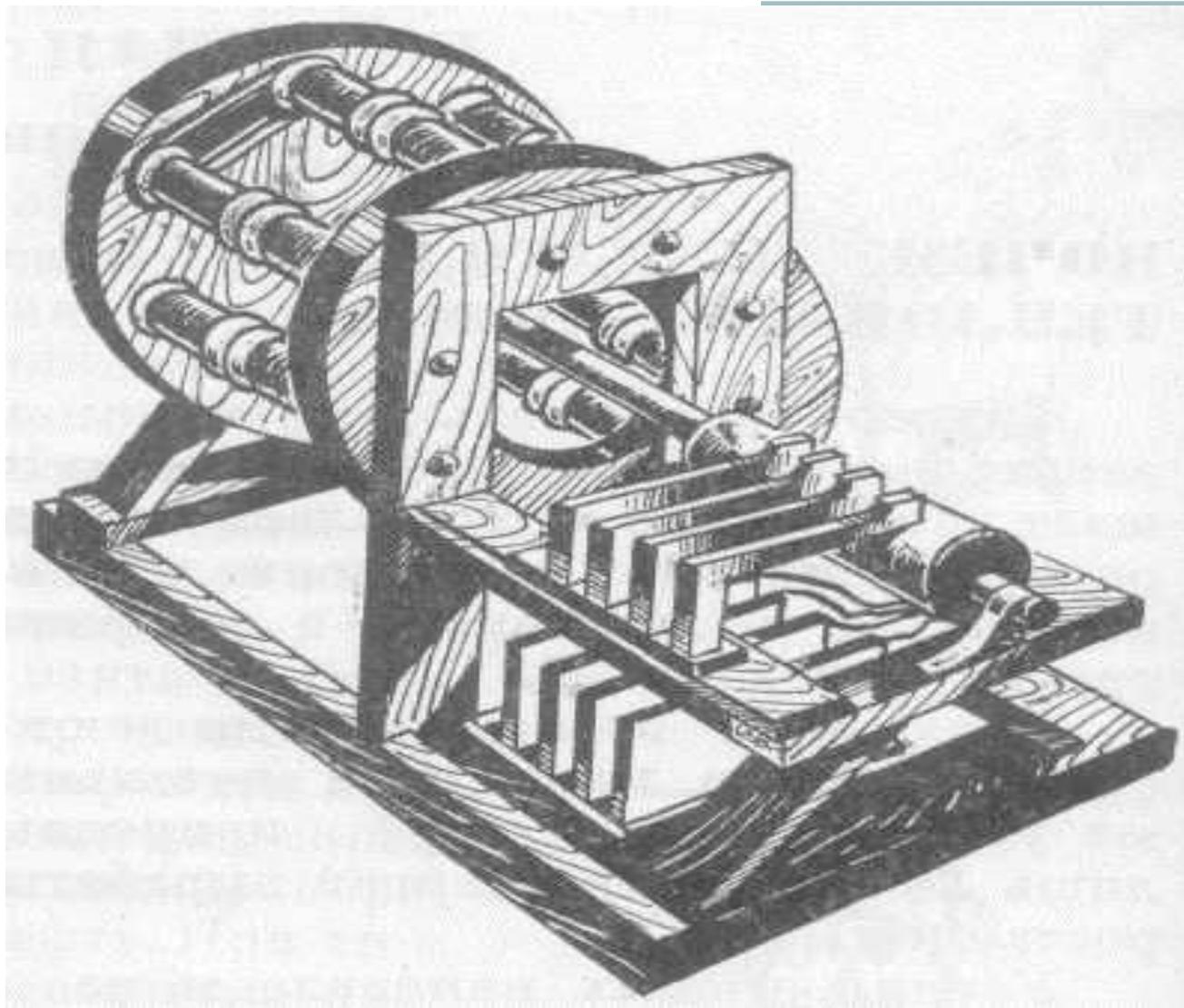
В 1834 г. петербургский академик Б. С. Якоби создал первый электрический двигатель. Он действовал от электрохимического источника тока.
