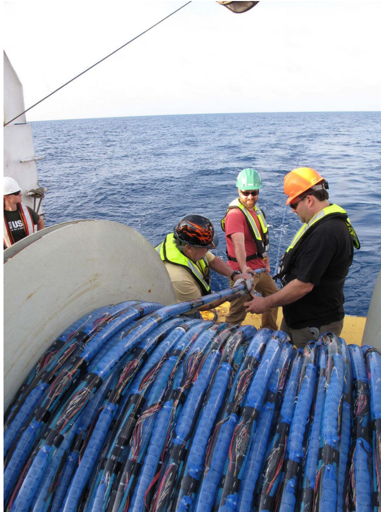
Морской приемник - сейсмокоса (=стример)
