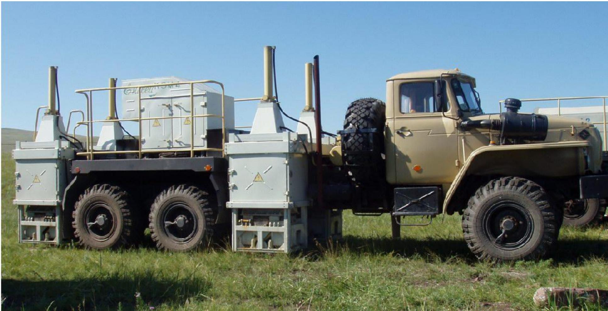
**Импульсный генератор сейсмических колебаний**
