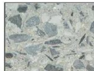
Высокопрочный порошково-активированный щебеночный бетон марок М 1300 - 2000
