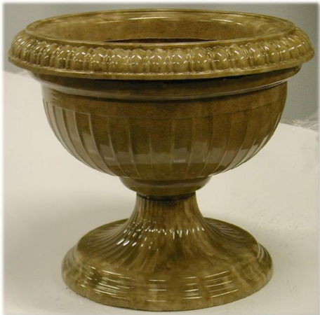
Малая напольная ваза, (размеры 45×45 см) и скульптура из цветного бетона марки М 1800 (г. Красноярск, ООО «Новые технологии строительства», кафедра ТБКиВ)
