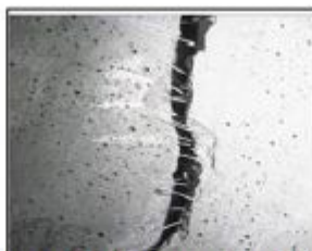
Дисперсно-армированный реакционно-порошковый бетон (фрагмент разрушения)
