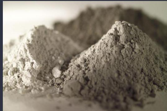
Его получают путем измельчения и обжига известковых пород, глины и различных минеральных компонентов. В зависимости от процента содержания в составе данных элементов, свойства и область использования цемента будут отличаться.
