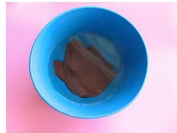
Разогревание термопластической массы в воде.
