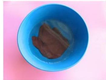
Разогревание термопластической массы в воде.
