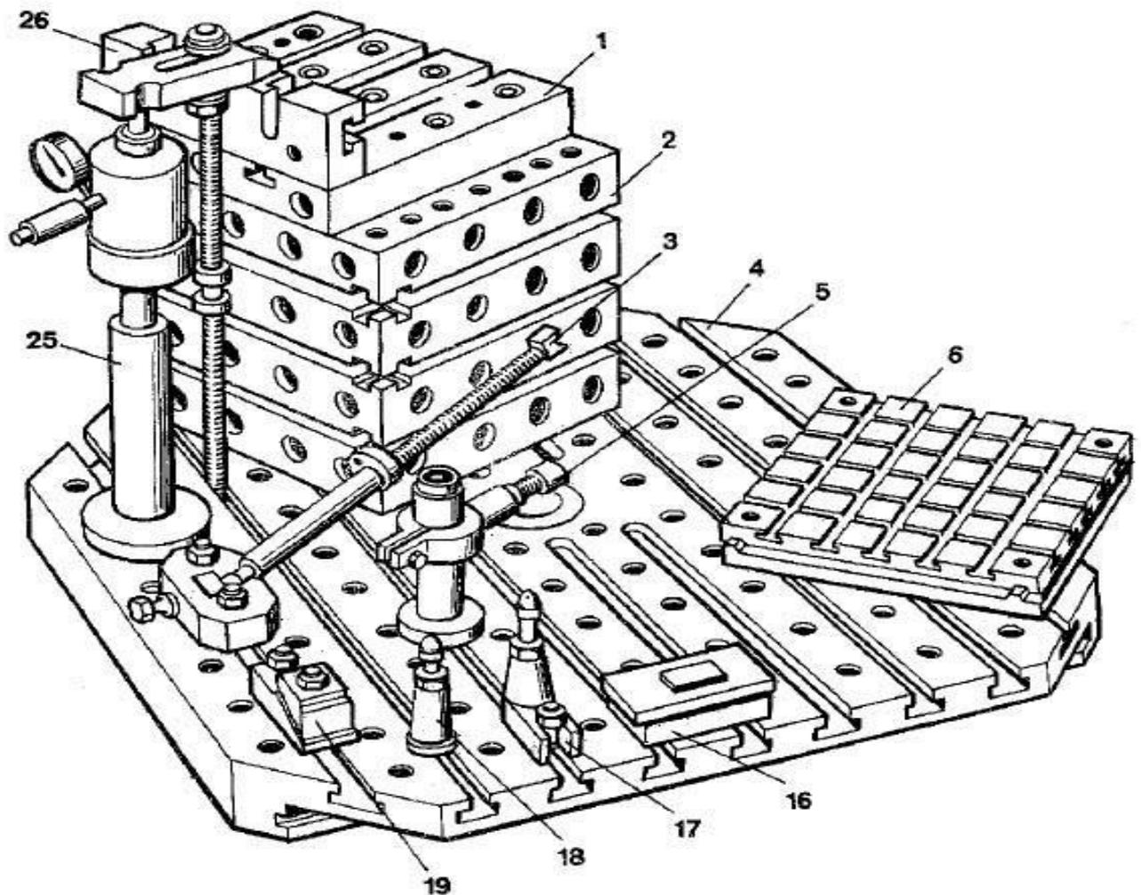
**Комплект СРП:** 1 — плиты опорные, 2 — секции угольника, 3 - распорки регули-руемые, 4 — плиты базовые, 5 — опоры регулируемые универ-сальные, 6 — плиты квадратные, 7- планки опорные однопазо-вые, 8 — планки опорные двухпазовые, 9 — планки опорные трехпазовые,
