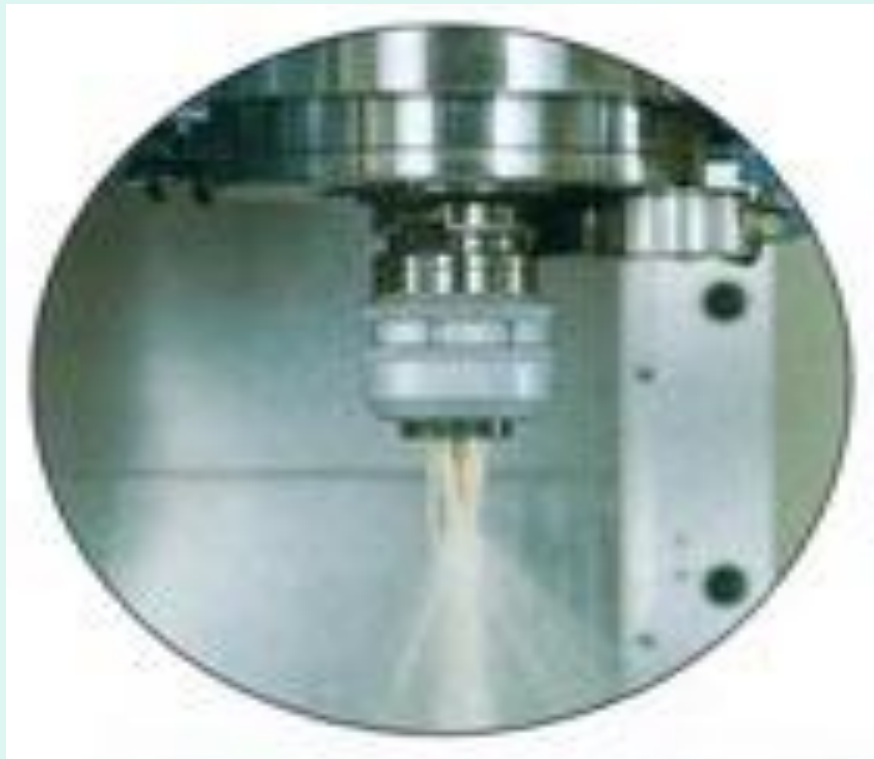
Фрезерный патрон с подачей СОЖ
