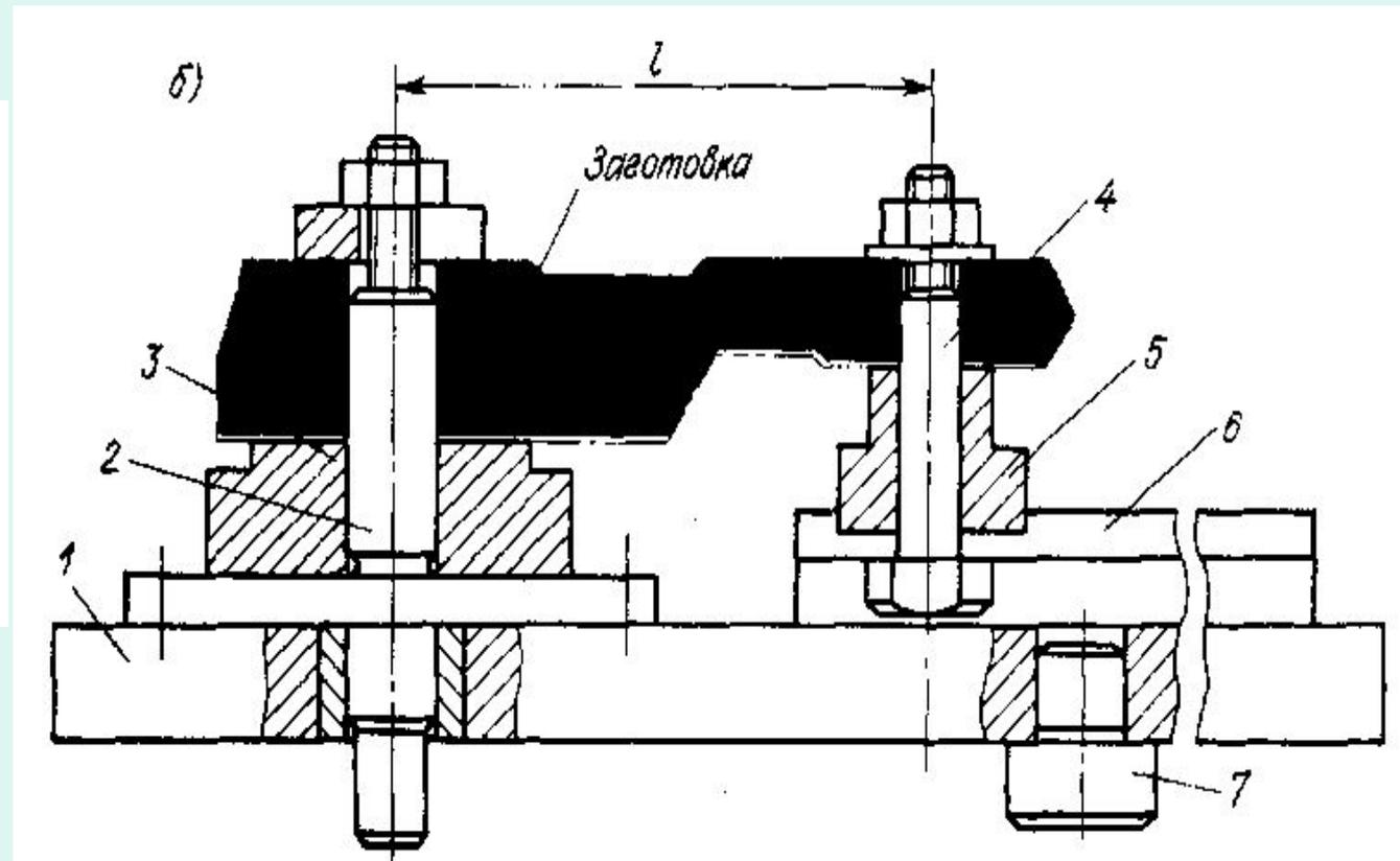
а — виды деталей; б — схема приспособления: 1 — базовая плита, 2 — сменная оправка, 3, 5 — опоры, 4, 7 — штыри.
