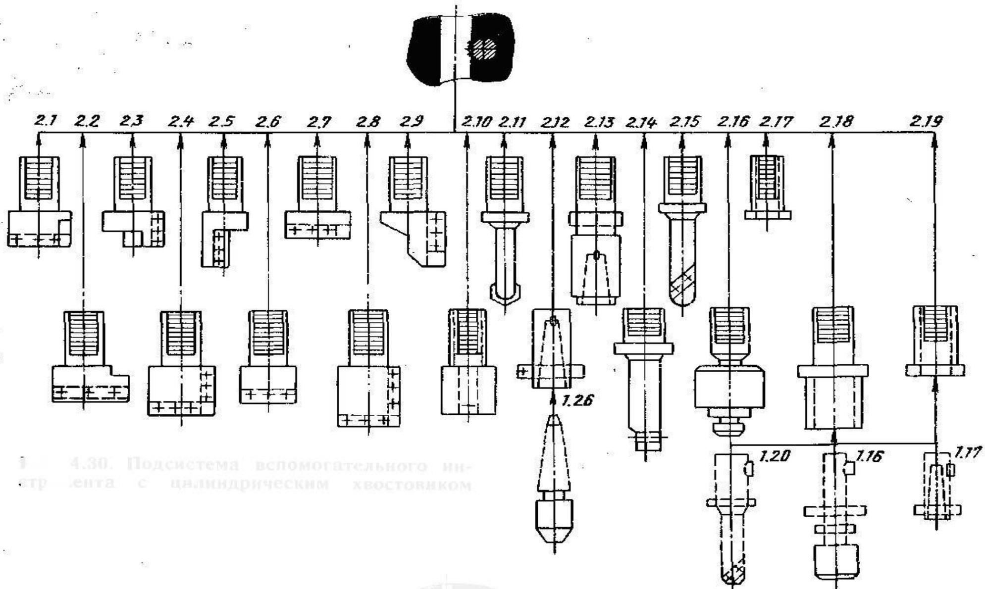
4.30. Подсистема вспомогательного инструмента с цилиндрическим хвостовиком
