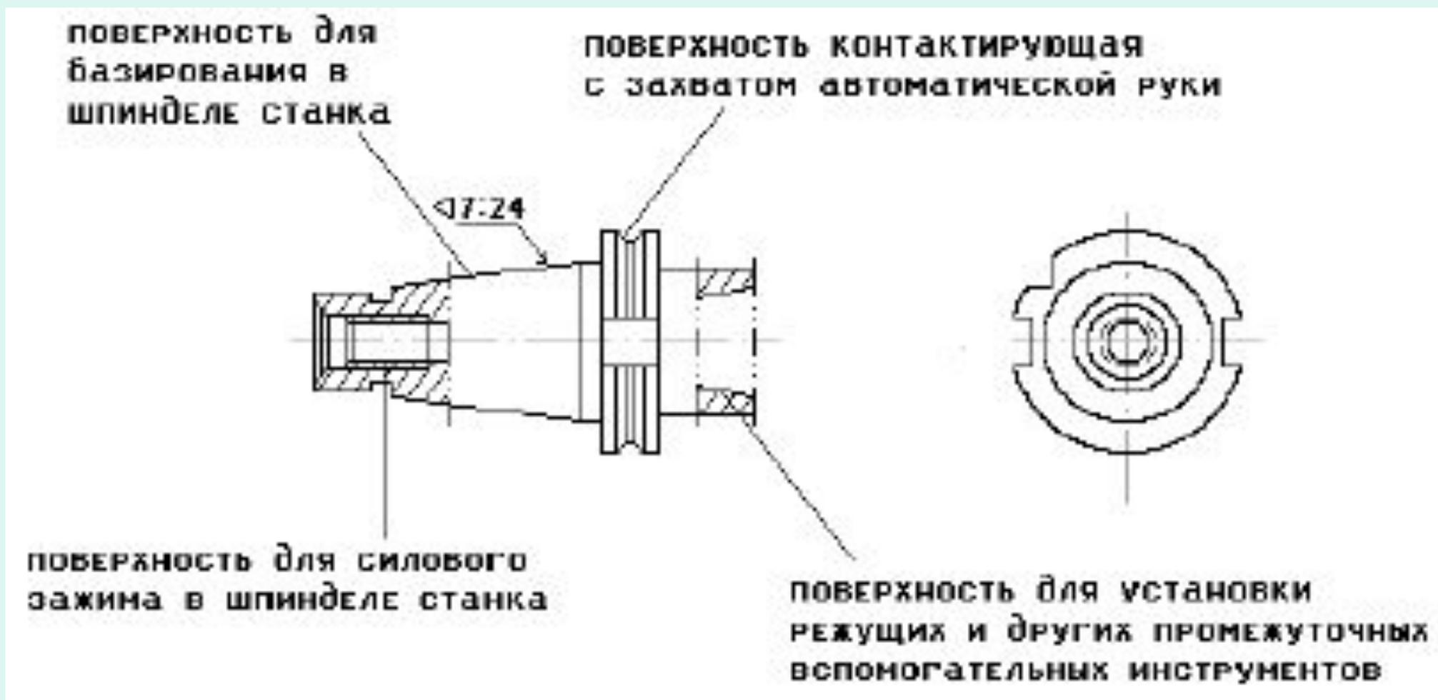
Хвостовик инструментального блока конусностью 7:24 для ОЦ
