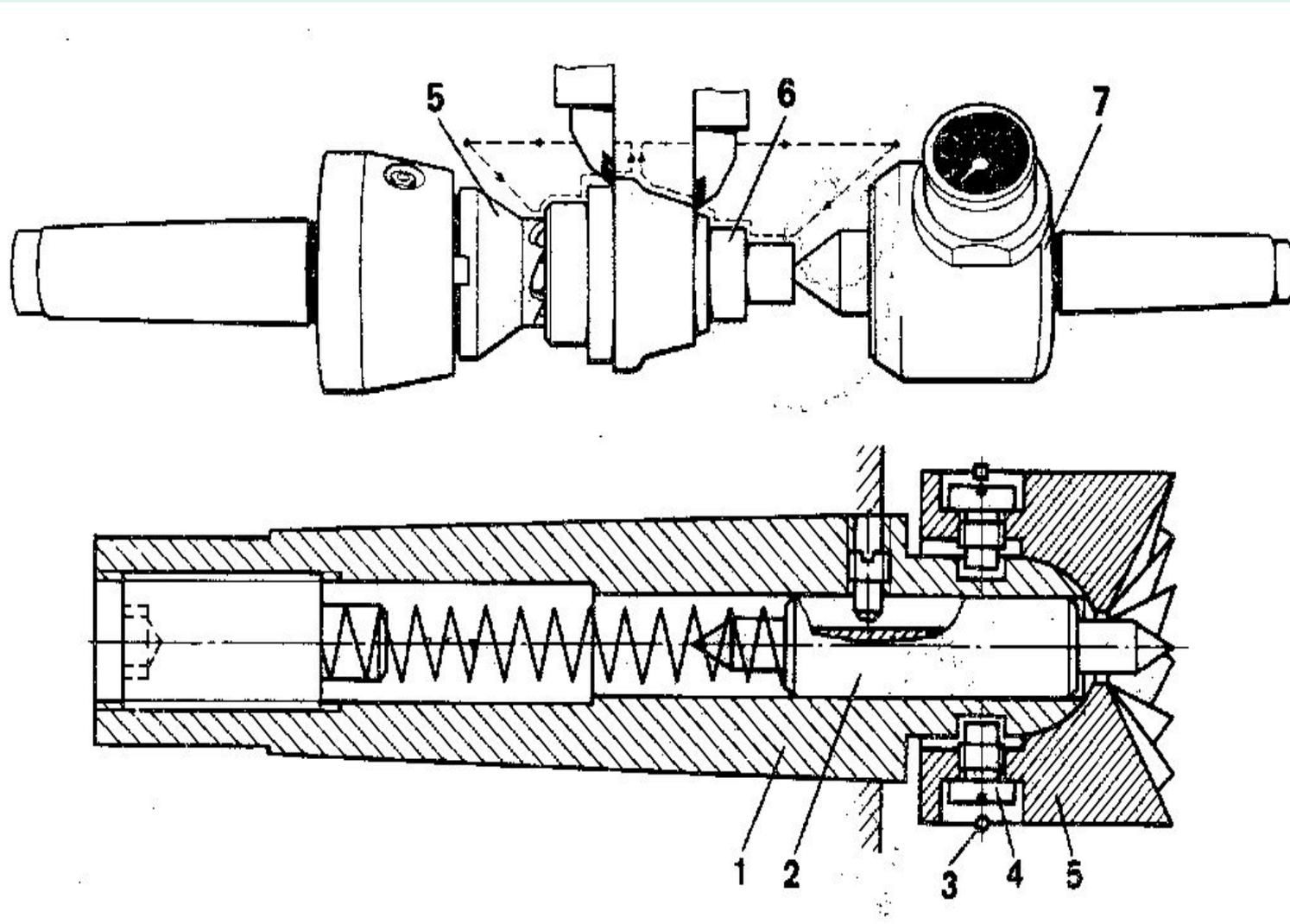
Используют при обработке деталей на токарных станках для передачи крутящего момента на заготовку от шпинделя станка с помощью или хомутка, или кулачков, или торцовых ножей, врезающихся в металл левого торца заготовки при поджиме ее задним центром к переднему.
