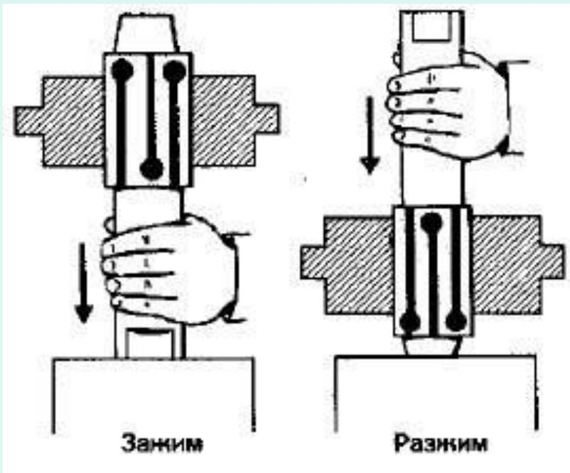
Предназначена для базирования и закрепления по внутренней цилиндрической поверхности заготовок деталей типа "фланец", "зубчатое колесо", "втулка", "стакан" при обработке наружных цилиндрических поверхностей на токарных станках с ЧПУ в условиях мелкосерийного и серийного производства.
