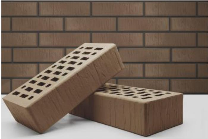
В производстве клинкерного кирпича используется тугоплавкая, так называемая «тощая» глина. В отличие от облицовочного кирпича, который обжигается при температуре 800-1000С, клинкерный кирпич обжигается при более высоких температурах 1100-1300С. Подобные технические условия обеспечивают клинкерному кирпичу однородную структуру, улучшенные эксплуатационные характеристики. За счет отсутствия пор в структуре клинкерного кирпича, он невосприимчив к перепадам температур и воздействию влаги.
