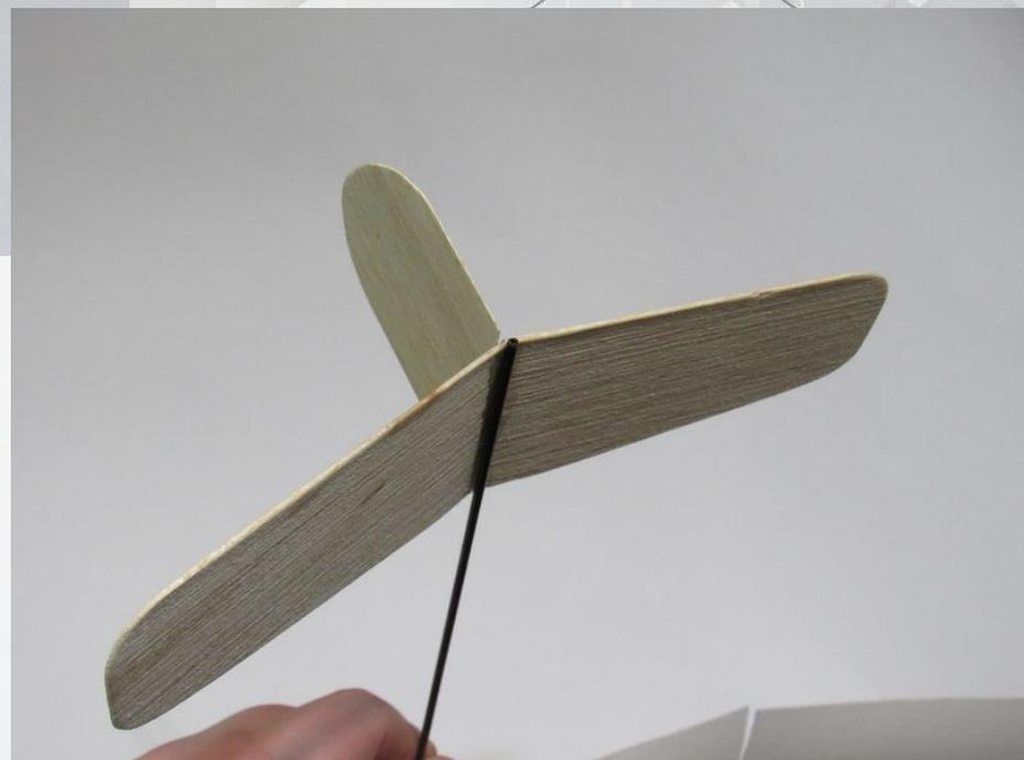
Для сборки модели необходима еще одна деталь – пилон. Для изготовления пилона берем бальзу сечением пять на пять миллиметров. Придаем симметричный профиль пилону. Приклеиваем пилон к крылу. Перед приклеиванием крыла необходимо определить центр тяжести модели. Он должен совпадать с чертежом. Согласно чертежу размечем место приклейки пилона крыла. Приклеиваем крыло к фюзеляжу.
