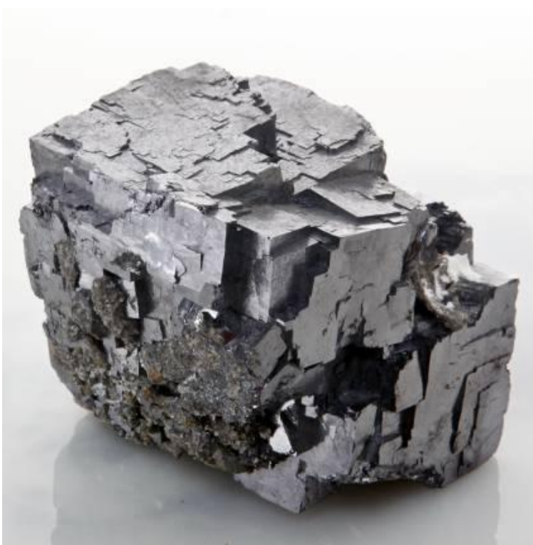
Галенит. Совершенная спайность по 3 направлениям (по кубу)
