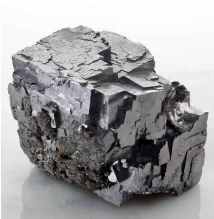
Галенит. Совершенная спайность по 3 направлениям (по кубу)
