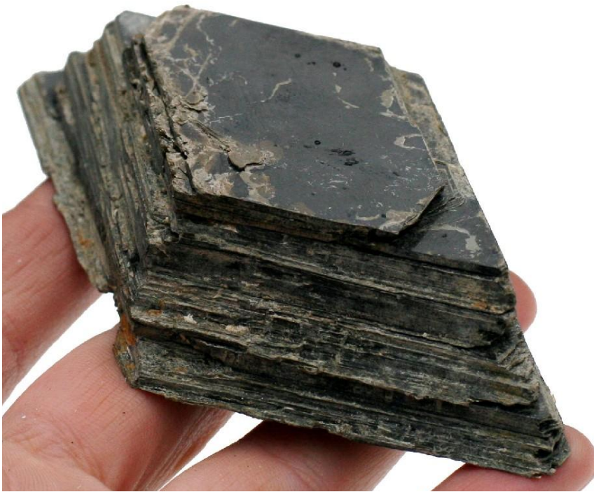
Слюда флогопит. Весьма совершенная спайность в одном направлении
