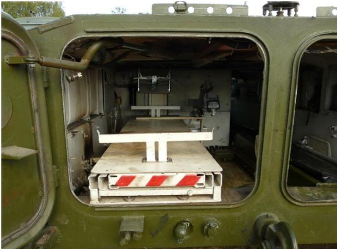
**Робототехнический комплекс предназначен для эвакуации и оказания первой медицинской помощи раненым в режиме дистанционного (безэкипажного) управления на удалении до 4 км.**
