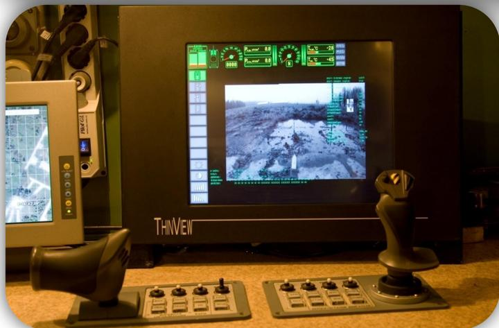
**Комплект навесного оборудования обеспечивает дистанционное управление вооружением и движением безэкипажного танка Т-72Б на удалении до 4 км.**
