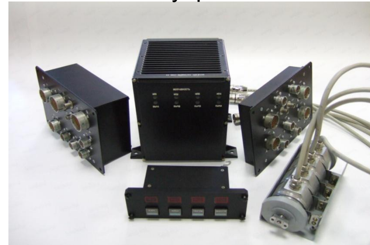
4-х кратно резервированная система управления
