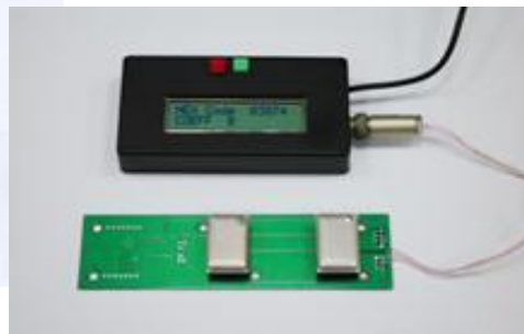
Инклинометр (датчик угла наклона) на базе акселерометра и микропроцессора
