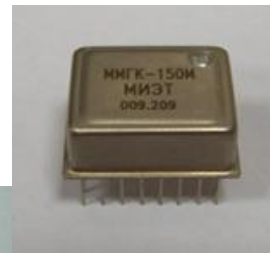
Микромеханический гироскоп (кольцевой)
