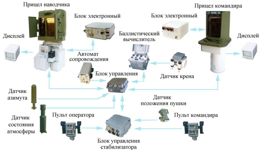
Система управления огнем с комбинированным прицелом наводчика и панорамическим прицелом командира
