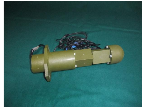
GPS-ГЛОНАСС датчик положения, атмосферного давления, скорости и направления ветра, температуры воздуха.
