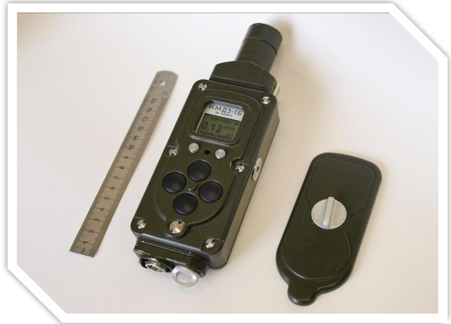
Общевойсковой прибор радиационной разведки и контроля ИМД-3 предназначен для ведения радиационной разведки и радиационного контроля в подразделениях войск в районах применения ядерного оружия, при авариях радиационно-опасных объектов, а также для обеспечения радиационной безопасности в воинских частях и учреждениях.
