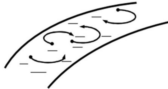
Рис.9.2. Линии тока при турбулентном течении
