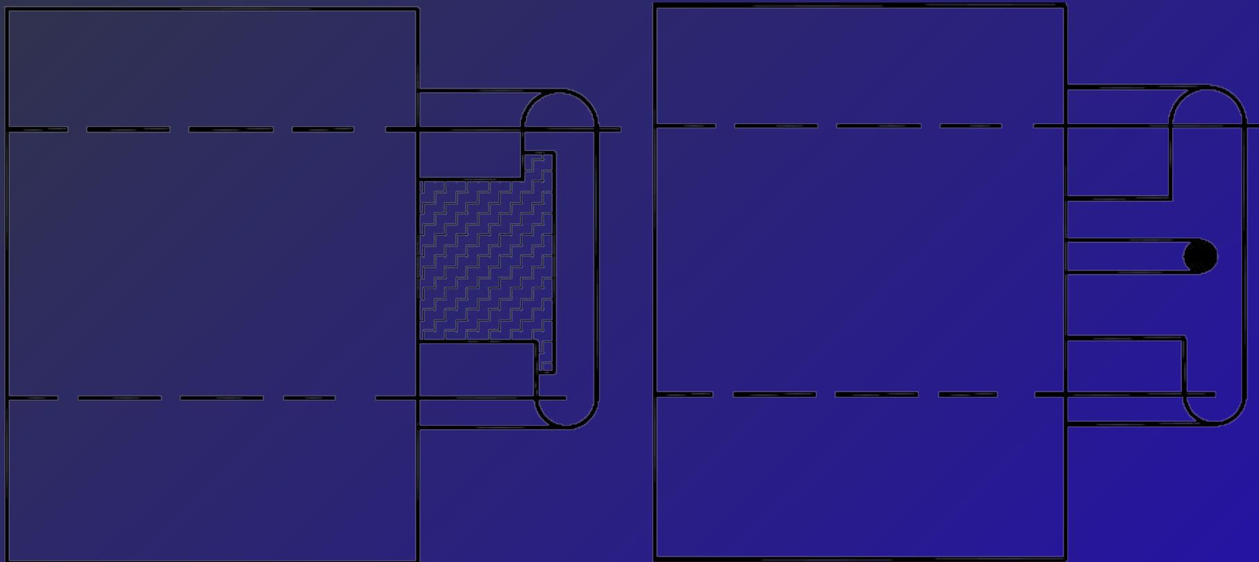
Рисунок 5. Схема соединения цельновыкроенного стана с «кулисой»
