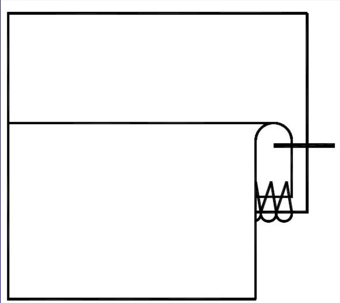
Рисунок 1. Схема соединения лифа с юбкой стачным швом взаутюжку
