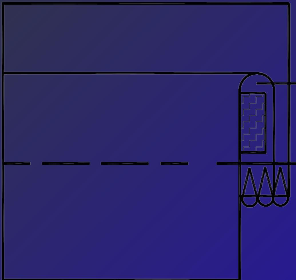
Рисунок 4. Схема соединения лифа с юбкой с прокладыванием эластичной тесьмы в шве соединения деталей
