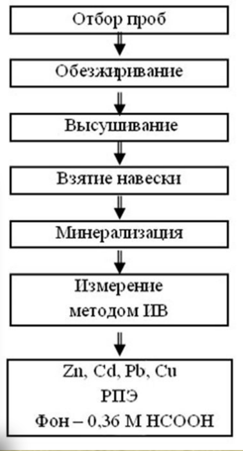
Схема 2. Основные этапы подготовки и анализа проб волос методом ИВ
