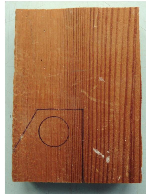
Размер кабины 35 х35 мм, окно – 14 мм.
