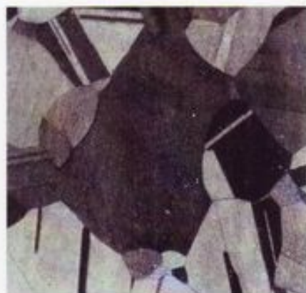
Структура однофазной латуни
