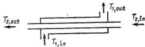
Рис. 1. Схема противоточного теплообменника
