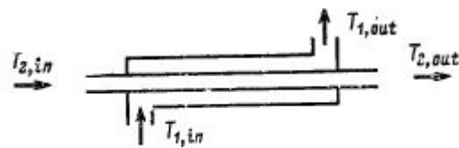
Рис. 2. Схема теплообменника с параллельным однонаправленным движением теплоносителей
