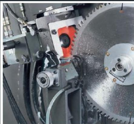
Установочная оправка с магнитным фланцем для точного центрирования полотна пилы
