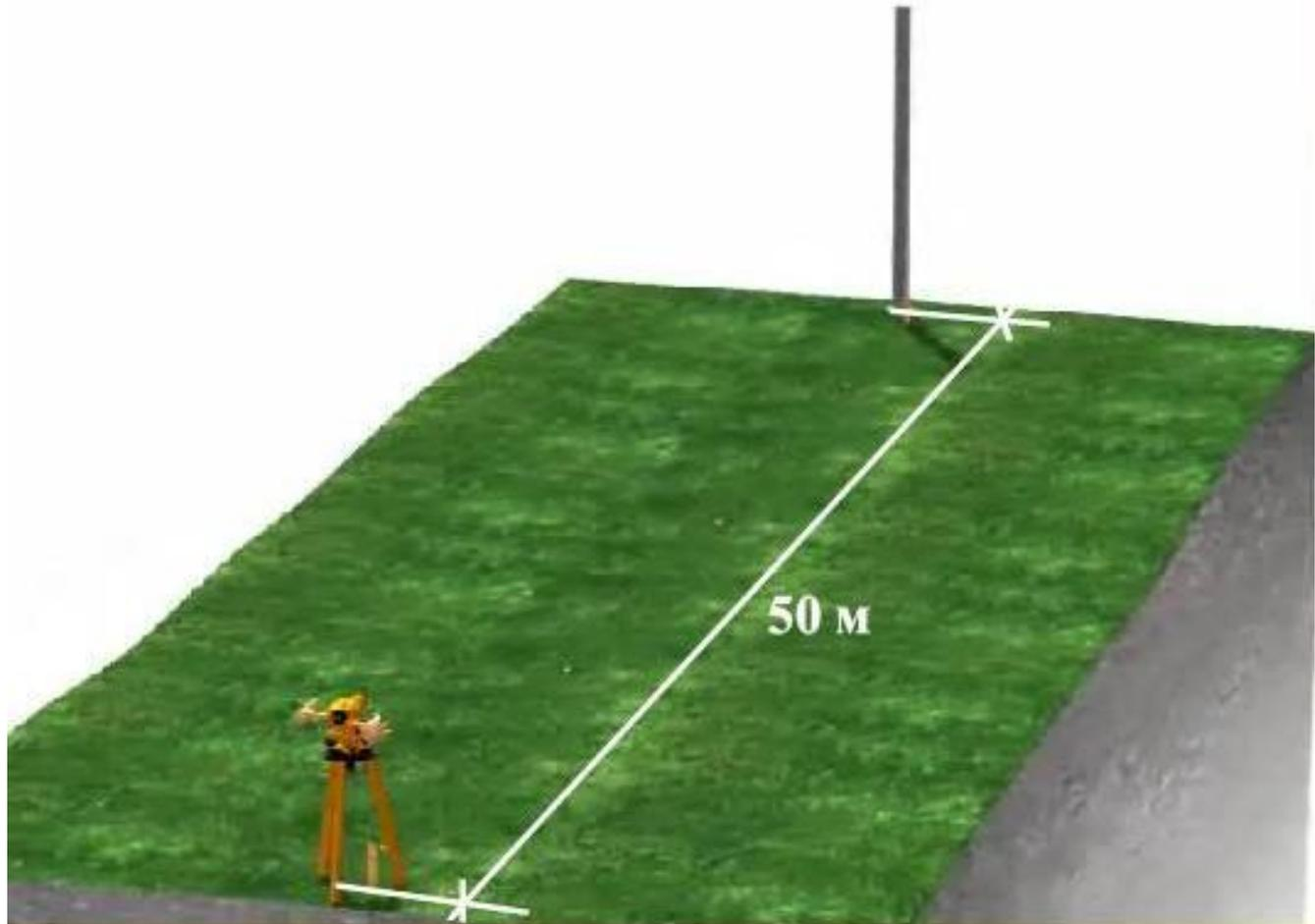
Поверка производится нивелированием одной и той же линии способом "вперед". На ровной местности выделяют линию длиной примерно 50 м.
