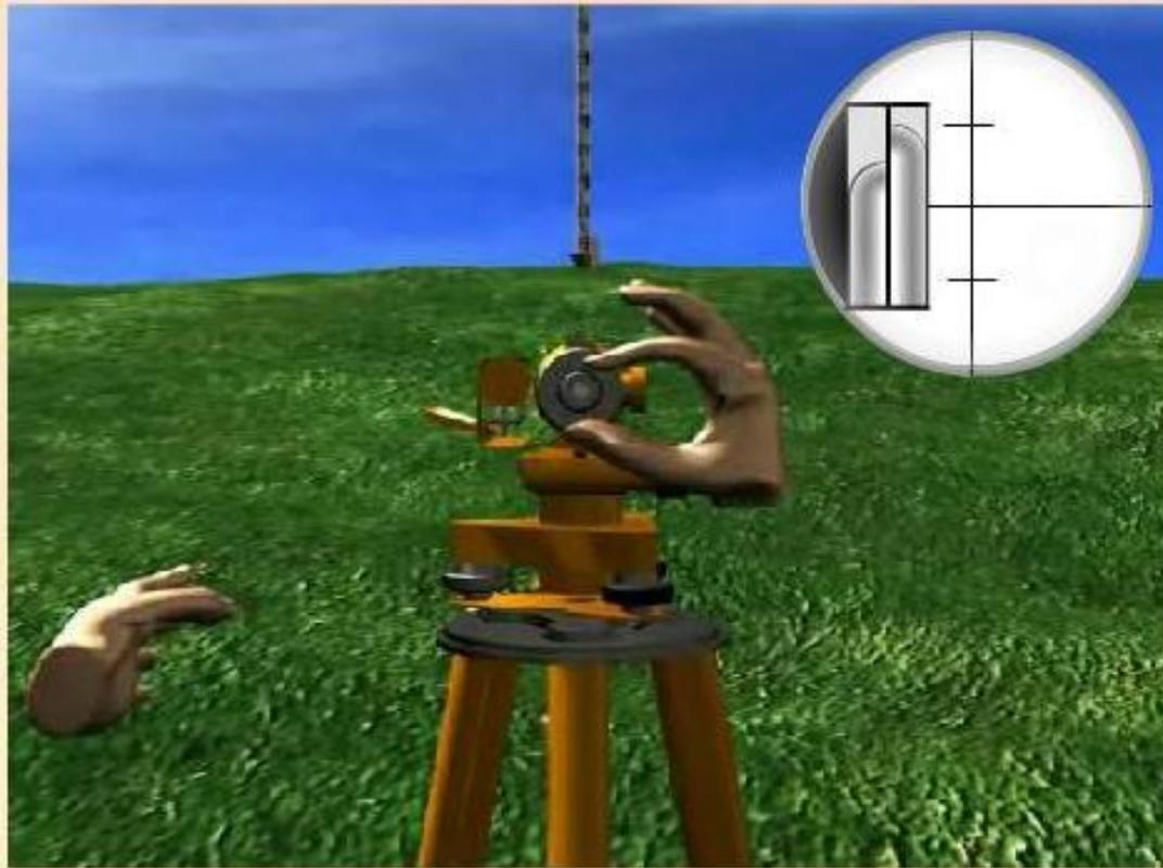
Установка трубы по глазу производится вращением диоптрийного кольца до наилучшей видимости нитей сетки, при этом труба должна быть наведена на светлый фон.
