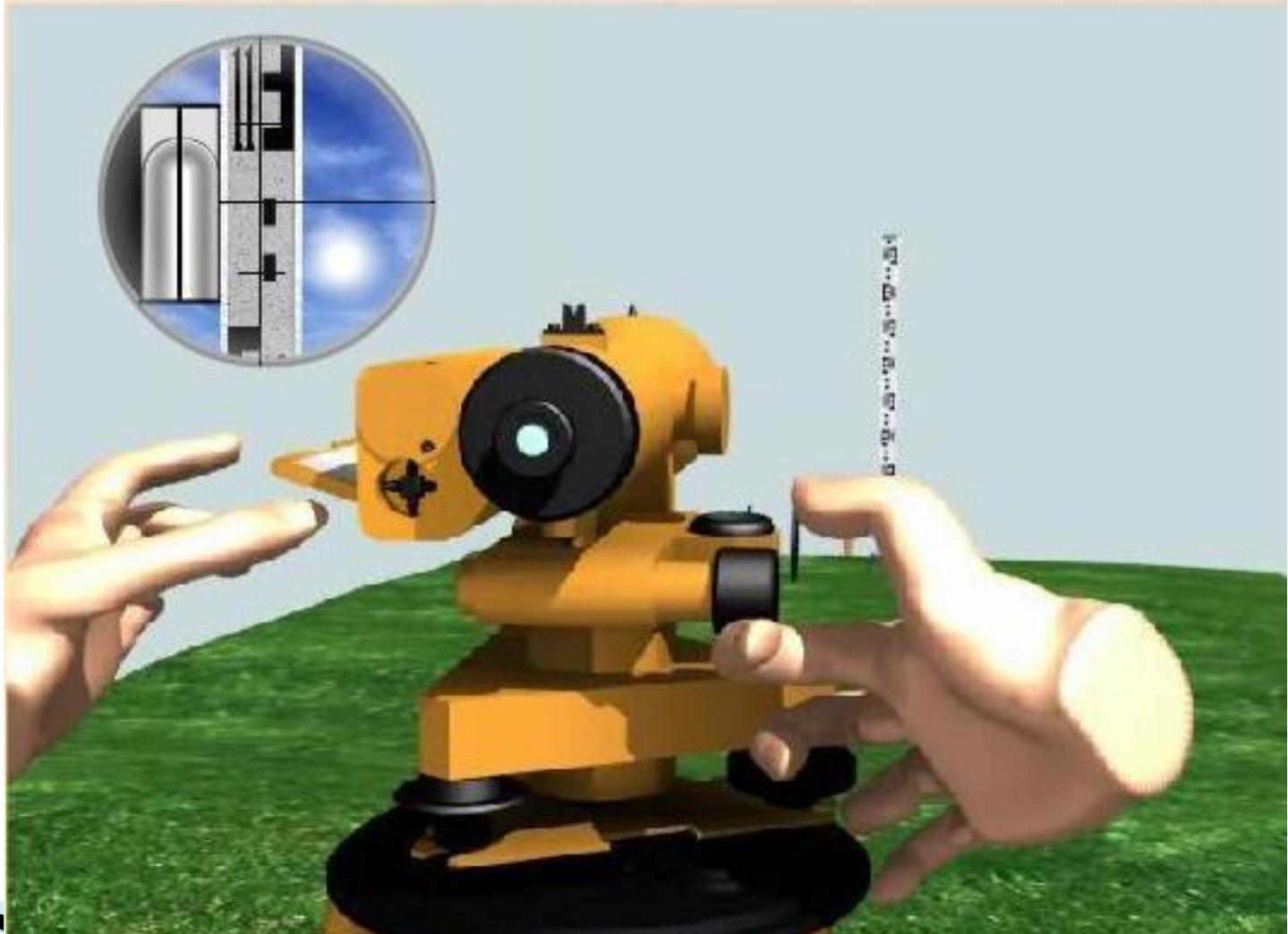
И производят расчет  $b_2$  по рейке, стоящей в точке В.
