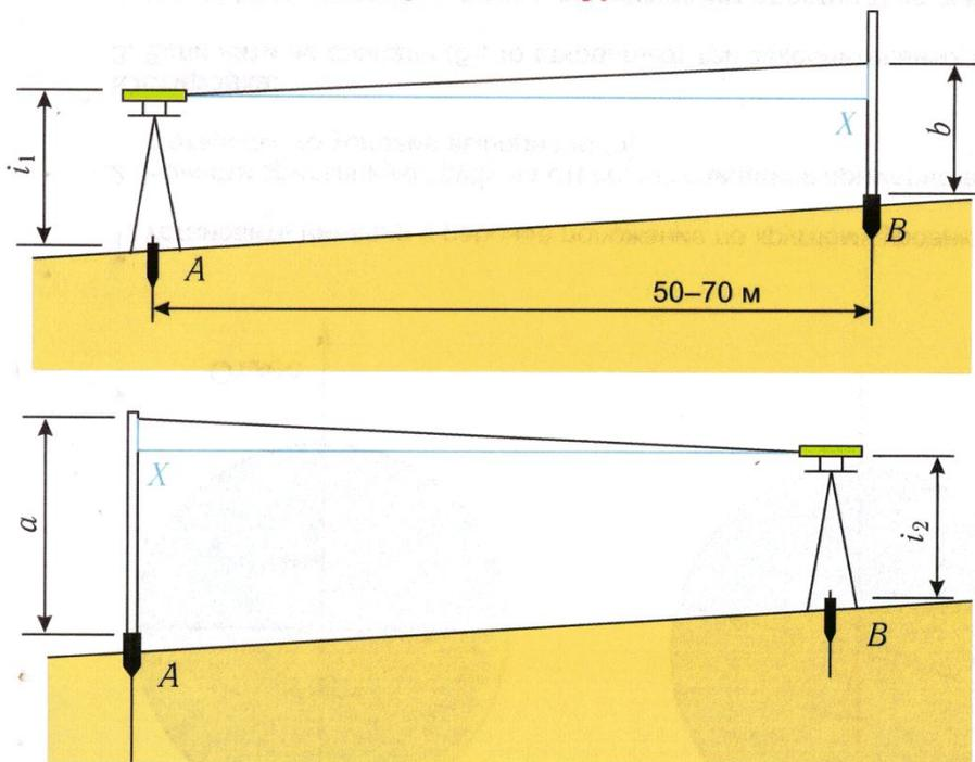
1. На местности с небольшим уклоном забивают 2 колышка на расстоянии 50–70 м.
