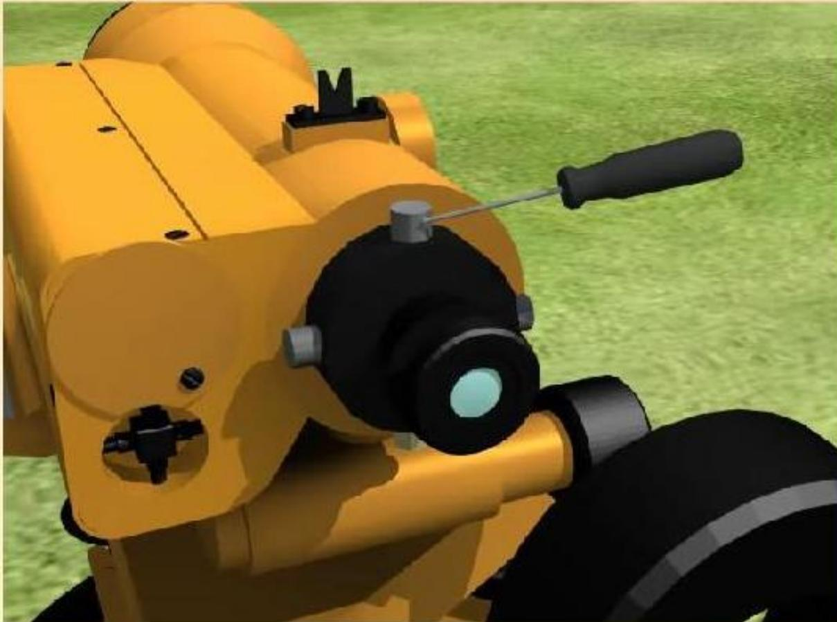
Поверку делают путем вращения трубы по азимуту. Выполнение этого условия гарантируется заводом. В полевых условиях, при необходимости, снять защитный колпачок и развернуть сетку нитей, предварительно ослабив четыре винта в торце окулярной части трубы отверткой.
