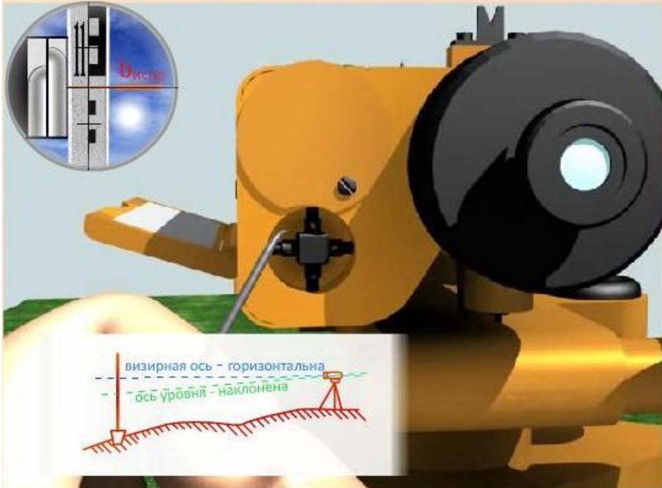
Наводим трубу на исправленный отсчет. В этот момент визирная ось придет в горизонтальное положение, а ось уровня отклонится, что будет заметно по расхождению концов пузырька.
