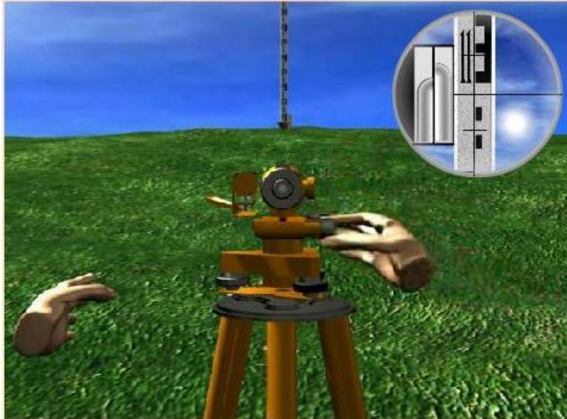
Элевационным винтом выравнивают положение пузырьков уровня в нуль-пункте, чему соответствует оптический контакт его половинок.
