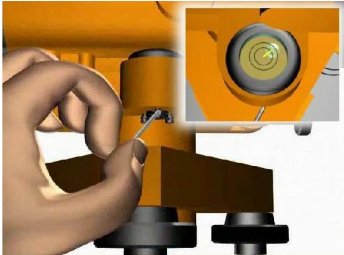
При отклонении пузырька от центра ампулы перемещают его к центру на **половину** отклонения с помощью исправительных винтов круглого уровня.
