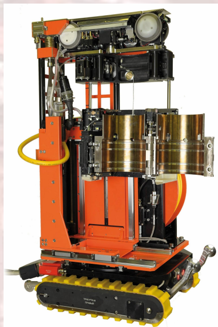
Ремонтный робототехнический комплекс восстановления ТСТ без извлечения ТК
