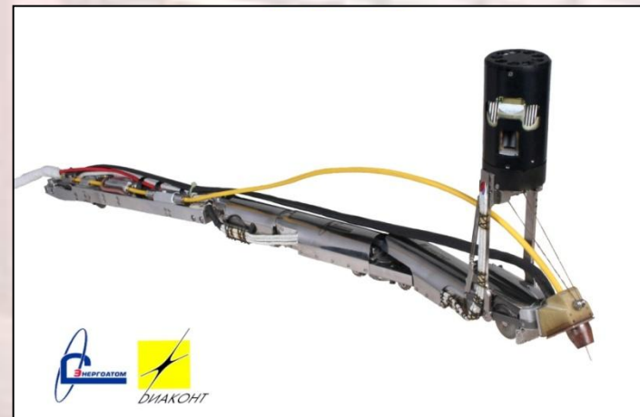
Ремонтно- диагностический комплекс для контроля и ремонта мест неплотностей БЗ РУ ЭП-6
