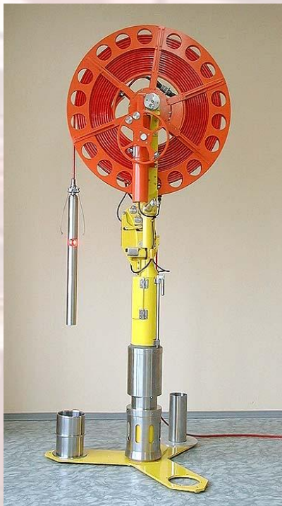
Инспекционный комплекс контроля каналов
