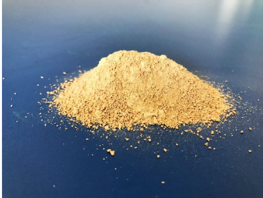
ДИАТОМИТ \text{SiO}_2 , \text{K}_2\text{O} , \text{Al}_2\text{O}_3 , \text{Fe}_2\text{O}_3 , \text{CaO}
