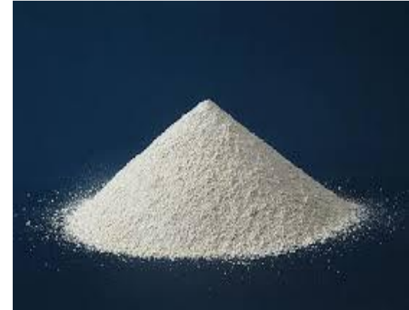
КАОЛИН \text{Al}_2\text{O}_3 \cdot 2\text{SiO}_2 \cdot 2\text{H}_2\text{O}
