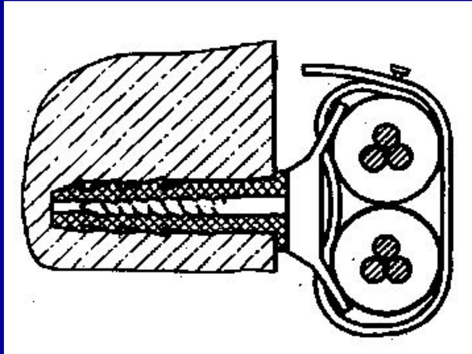
Закрепление кабелей распорным дюбелем, закрепом и полоской-пряжкой, бандажной полоской с кнопкой
