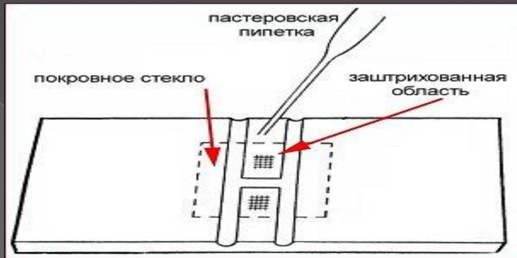
При заполнении камеры, каплю исследуемой жидкости наносят на выступающий конец средней площадки и в силу капиллярности капля подтекает под покрывное стекло и покрывает сетку
