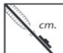
Двоколійна залізниця. Станція. Виймка
